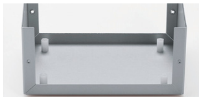
スペーサー部品をネジ止めしている
