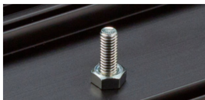
サラネジをナットで止めスタッドにしている
