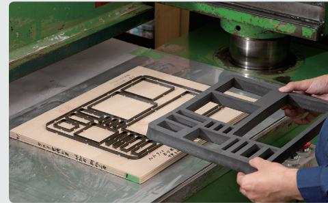
タカチではスponジ専用のカッティングマシンにより、
