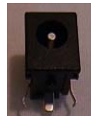
写真 4-6 DCジャック
