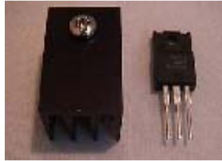
三端子レギュレータ（右） 放熱板（左） 写真 4-7
