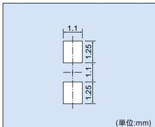
はんだ塗布用マスク厚みは100~150  $\mu\text{m}$  のものを使用し、開口部は推奨パターンと同等かそれ以下に設定する事をお奨めします。
