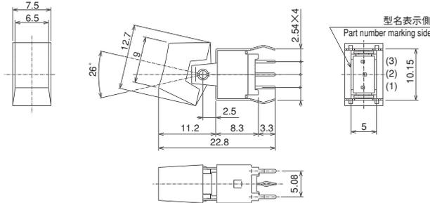
ボックスには端子番号を表示していません。Terminal numbers are not shown on the bottom of the switch.
