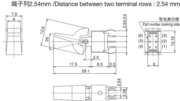
ボックスには端子番号を表示していません。Terminal numbers are not shown on the bottom of the switch.
