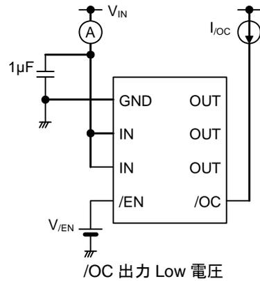
Figure 4. 測定回路
