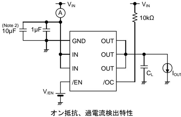
(Note 2) 電源装置を使用して出力地絡試験をする際には 10μF 以上の低 ESR Capacitance を御使用ください。
